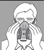
Test d'étanchéité à pression négative
