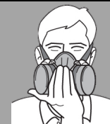
Test d'étanchéité à pression positive
